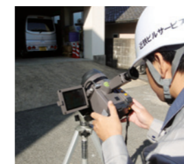
サーモグラフィによる外壁診断
